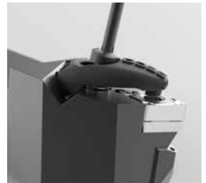
Wendeplattenwechsel leicht gemacht mit JETI - Jetstream Tooling Integrated.
